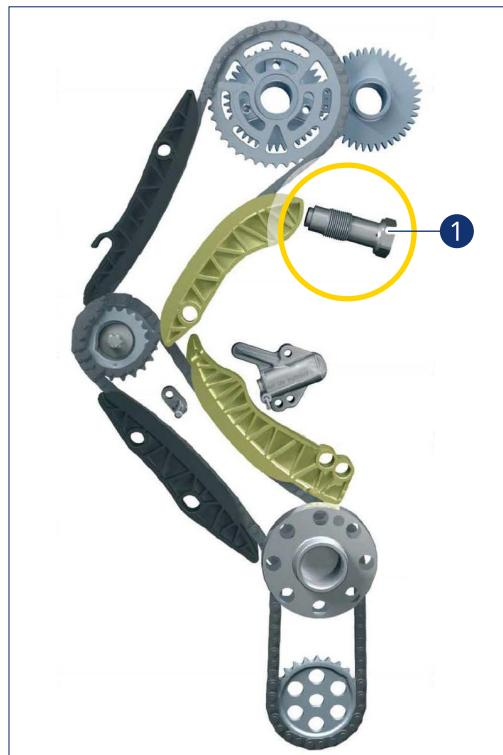
**En un número limitado de vehículos,** esta variación en la longitud del eje roscado requerirá que se modifique la carcasa de la cabeza. Esta modificación será necesaria para poder ajustar correctamente el tensor.
