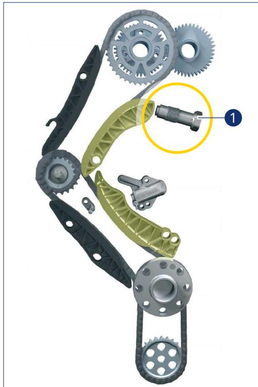
**Sur un nombre limité de véhicules**, cette variation de longueur de la tige filetée nécessitera de modifier le logement sur la culasse. Cette modification sera nécessaire afin de pouvoir monter correctement le tendeur.
